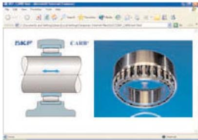
CARB融合了球形滚子轴承的自调整特性、圆柱形滚子轴承的轴向对准特性、以及滚针轴承的小截面高度且大承载能力的特性。它专门作为非定位轴承来使用。这种全新轴承为节省空间、减轻重量和降低排列成本提供了新的可能。CARB的应用现在包括造纸机、连铸机器、变速箱、风车、电动机、甘蔗切碎机、移动起重机/滚轮、压缩机和风力发电厂。另外，它还可以被当作转向系统中防止摆动的一种自由轴承来使用。
