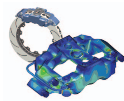
利用 Pro/ENGINEER Mechanica 可以对像这样的制动器模型进行验证，从而减少所需的实物样机数量。
