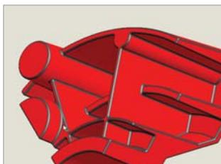
利用 Auto Round™ 加快设计过程。简化重复性任务，并缩短在模型上创建倒圆角特征的时间。Pro/ENGINEER 分析选定的边，然后创建优化的倒圆角特征序列。有这么一项倒圆角任务，中级用户和专家级用户完成它的时间分别是 90 分钟和 20 分钟，而 Auto Round 可以在 40 秒内完成整个任务！
